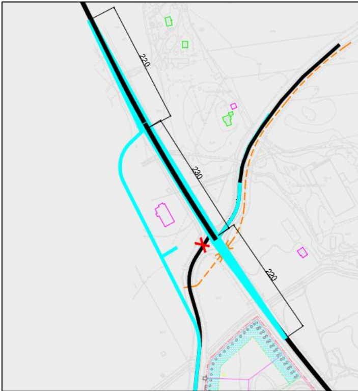
Kuva 9. Porrastus VE2, jossa vasemmallekääntymiskaistat ovat porrastusvälillä ja porrastusväli on mitoitettu niiden mukaan. Porrastussuunta on oikea-vasen-tyyppiä.
